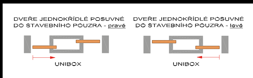
Horizontální řez pouzrem NORMA LINE Unibox
